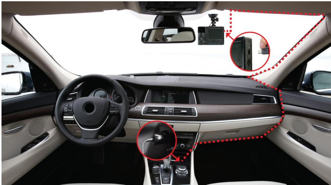
1. Connectez la petite extrémité de l'adaptateur de voiture au connecteur USB du DrivePro.
