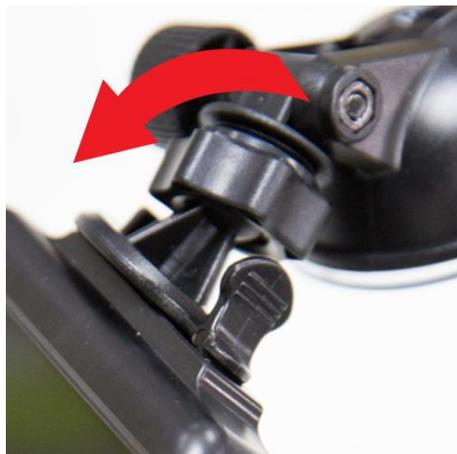
5. Une fois que le DrivePro est dans la meilleure position, tournez le bouton de réglage dans le sens des aiguilles d'une montre pour vous assurer que la caméra est bien verrouillée en place.
